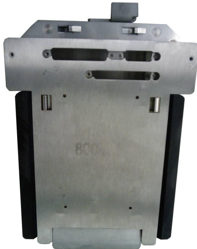
Abbildung 16: Mobile Halteplatte mit aufgesetzter Montagevorrichtung.
